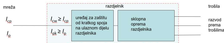
Slika 4. Uvjeti za priključenje razdjelnika na mrežu
